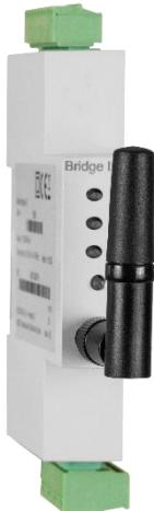
O **Bridge LR** é uma ponte que converte o ambiente físico RS-485 para uma rede sem fios de longo alcance LoRa™. O dispositivo é totalmente configurável através de uma aplicação que se utiliza para configurar qualquer parâmetro da porta série RS-485 ou do rádio LoRa™.
